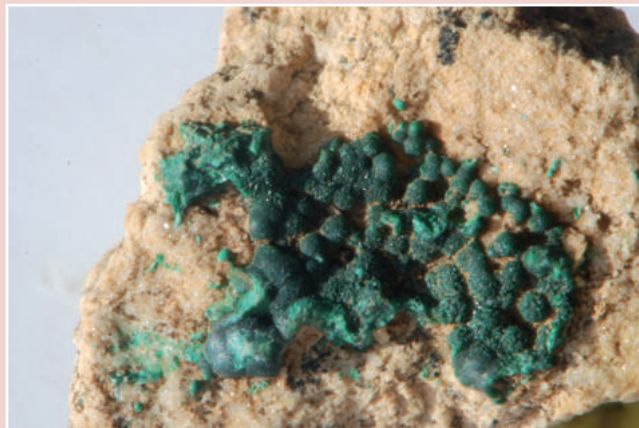
Fig. 3.1.19. Drusa de cristales de malaquita en agregados botroidales sobre dolomita.
